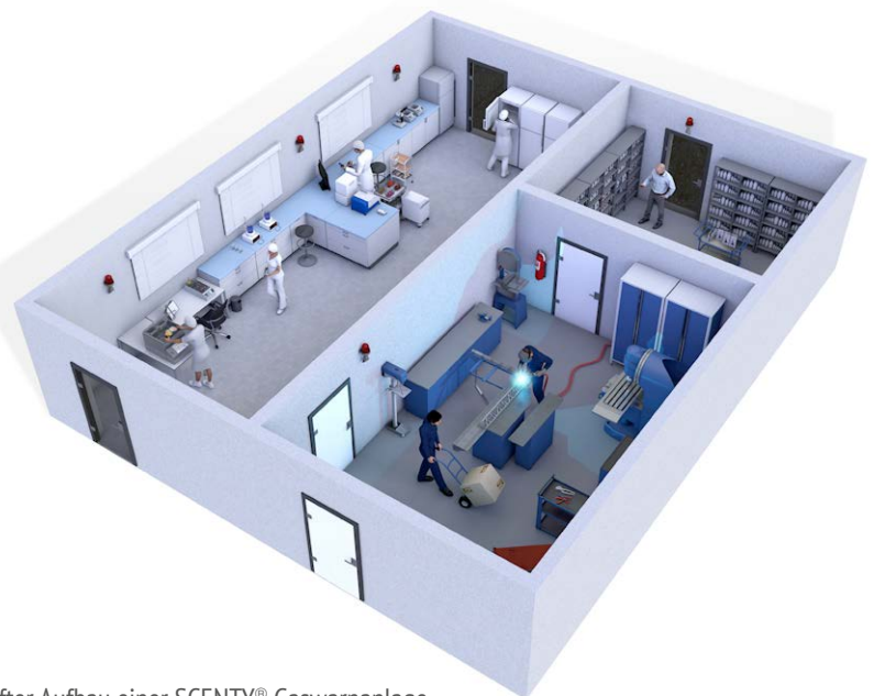
Beispielhafter Aufbau einer SCENTY® Gaswarnanlage
